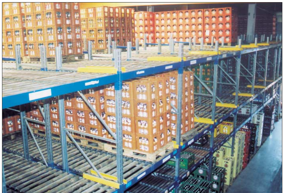
Im neuen Palettendurchlaufregal lagern vorwiegend die sogenannten Schnelldreher – in der Mehrzahl diverse Mineralwassersorten.
