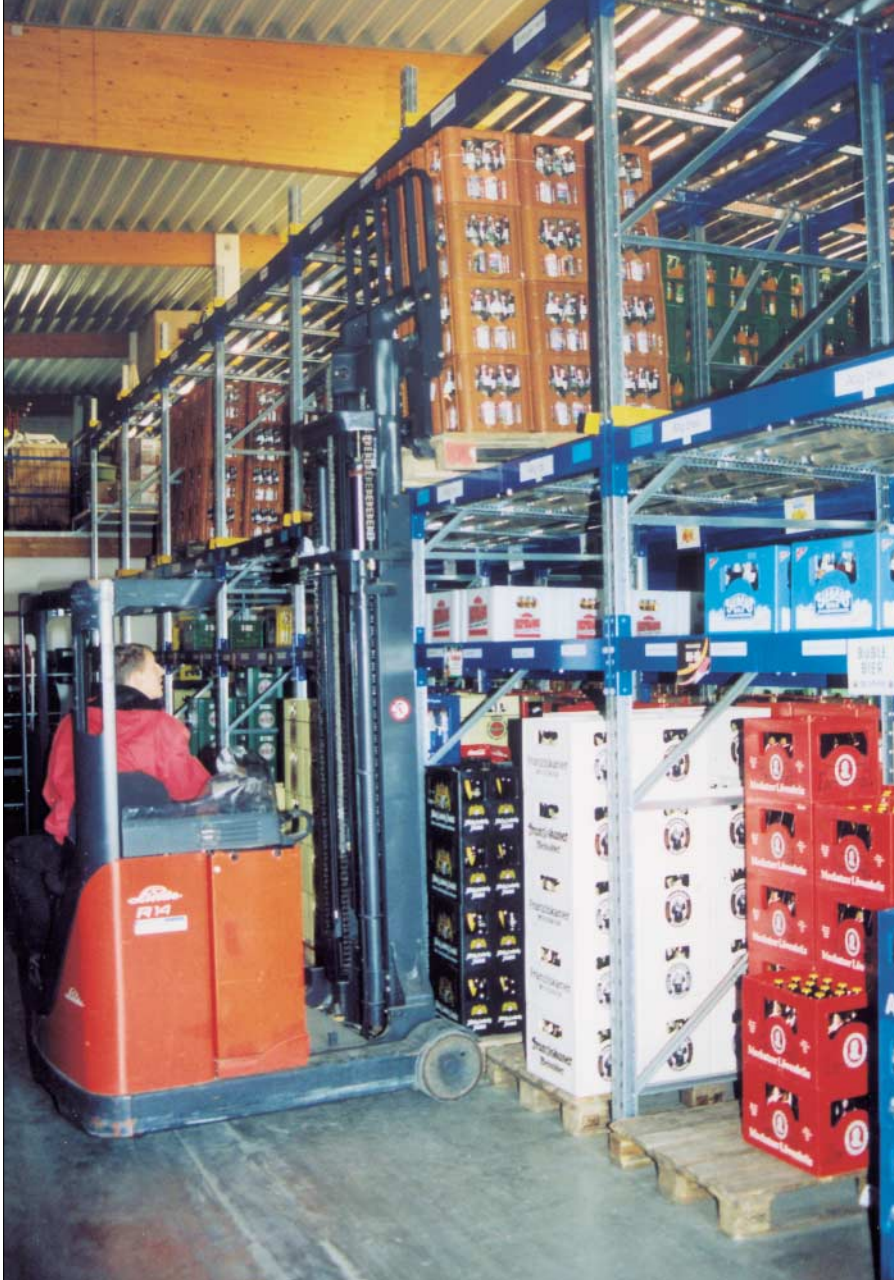
Einer der größten Vorteile der dynamischen Palettendurchlaufanlage gegenüber statischen Palettenregalen ist die räumliche Trennung von Wareneingang und -ausgang.
